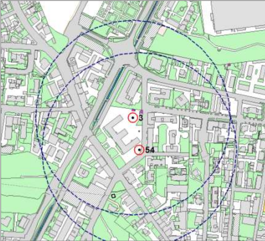
P3 Localizzazione testa e ZTA/ZdR pozzo nel cortile delle scuole
