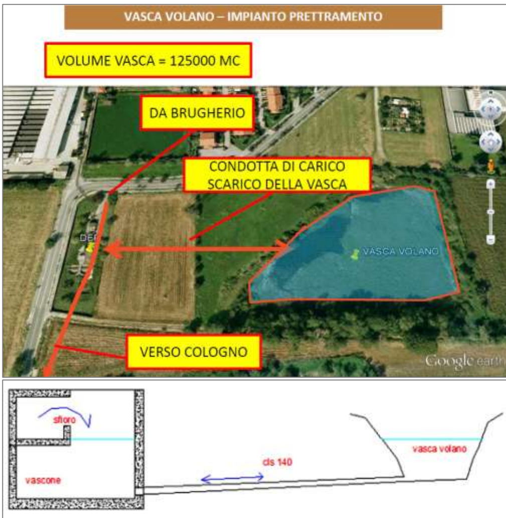
Figg.3.32-3.33 Rapporti tra rete e vasca volano e schema funzionamento a gravità della stessa (da documenti CAP)
